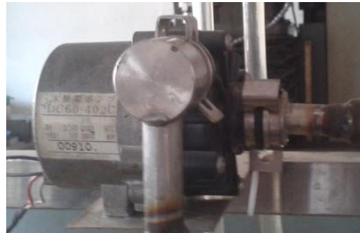
Hình 7.30 Bơm hoàn lưu
