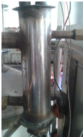
Hình 7.20 Bồn chứa điện trở nạp liệu
